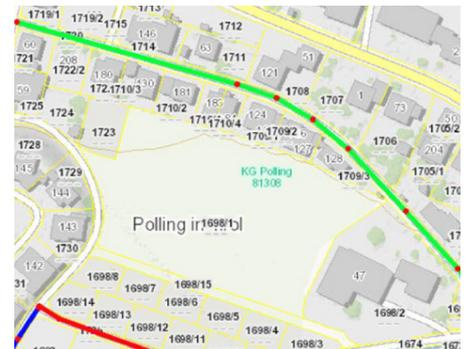
Einen großen Sanierungsumfang stellt auch der Abschnitt beginnend bei Gp 1700 im Osten bis zur Gp 1719/1 im Westen dar. Entlang der ca. 310 Meter langen Strecke (grüne Linie) werden ebenfalls Straßenbelag, Wasser- und Kanalleitung saniert und eine Glasfaserleitung mitverlegt.
